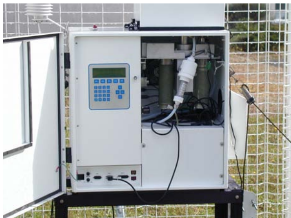
Figure 2: Préleveur bas-volume Partisol 2000
