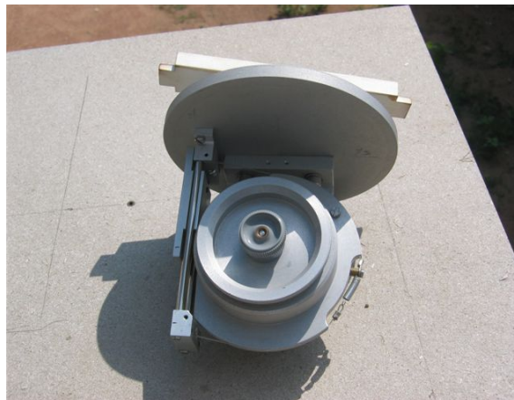
À l'intérieur du capteur, les pollens se collent sur le tambour.
