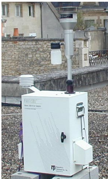
Illustration 5: Système de prélèvement pour les métaux lourds
