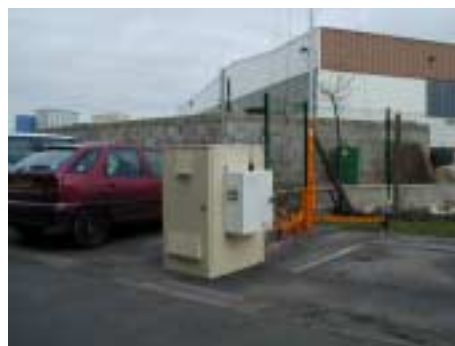
Figure IX.1 : Système de prélèvement Partisol plus et Système TEOM – ACCU – Mât météorologique
