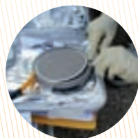
Prélèvement de métaux sur filtre
